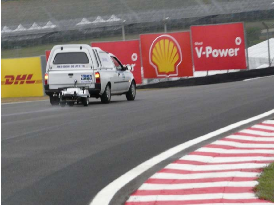
foto 7 –Execução do levantamento de aderência pneu/pavimento
