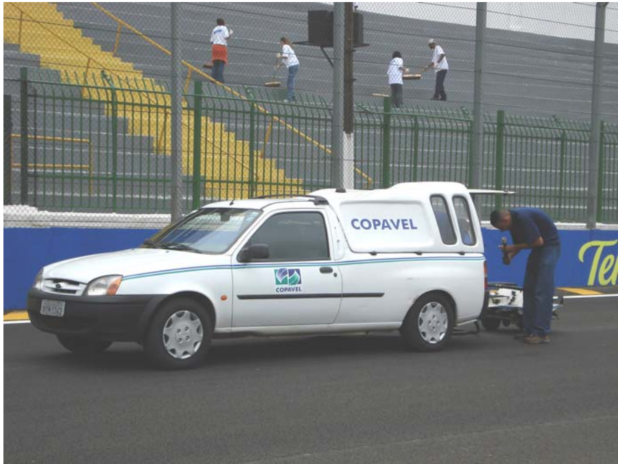
foto 3 – Montagem do equipamento Grip Tester
