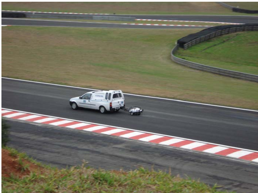
foto 6 –Execução do levantamento de aderência pneu/pavimento
